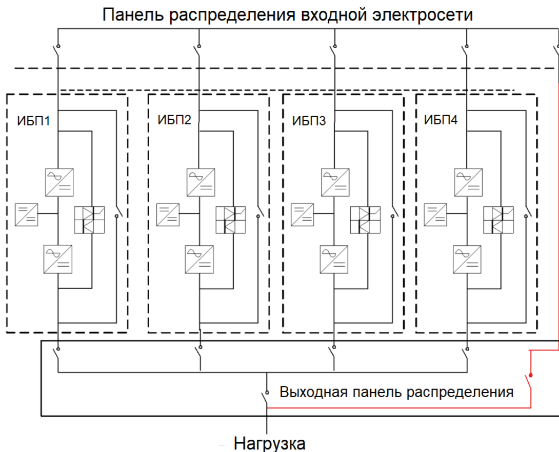
Рисунок 5.9. Схема параллельного подключения ИБП
